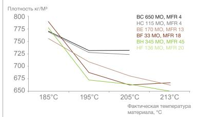
РР, начальная плотность 900 кг/М³, с различной скоростью течения расплава анализировался в процессе литья под давлением при различных температурах с 3 процентами Expancel 980 DUX 120. Для достижения оптимального расширения рекомендуется высокая скорость течения расплава пластической массы.
